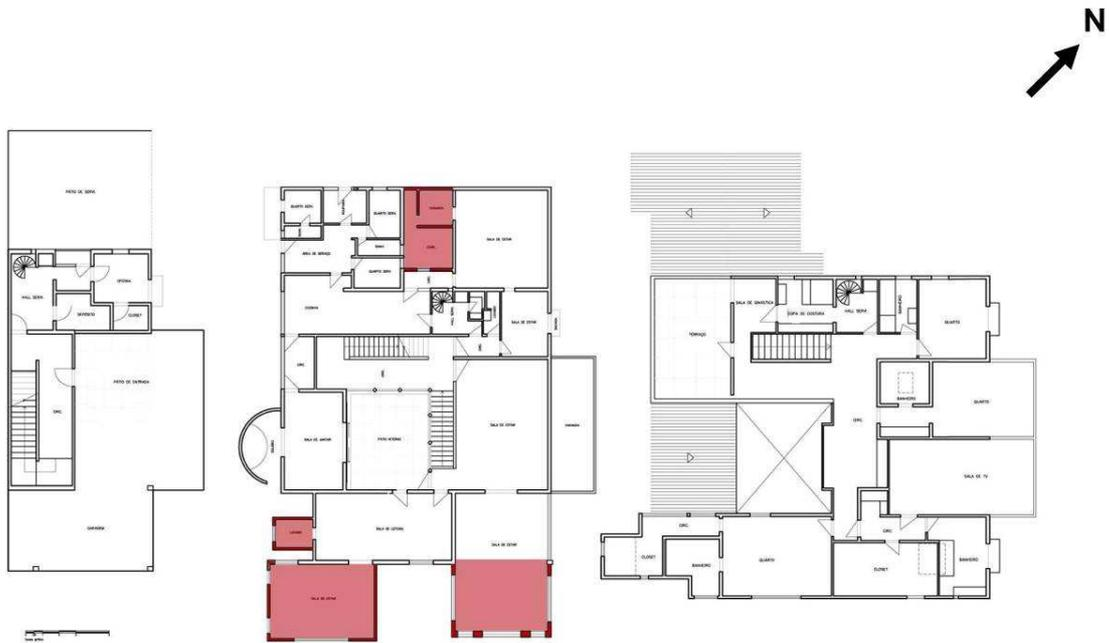
Figura 24 – Plantas baixas do primeiro, segundo e terceiro pavimentos com indicação em vermelho das pequenas alterações na arquitetura original
