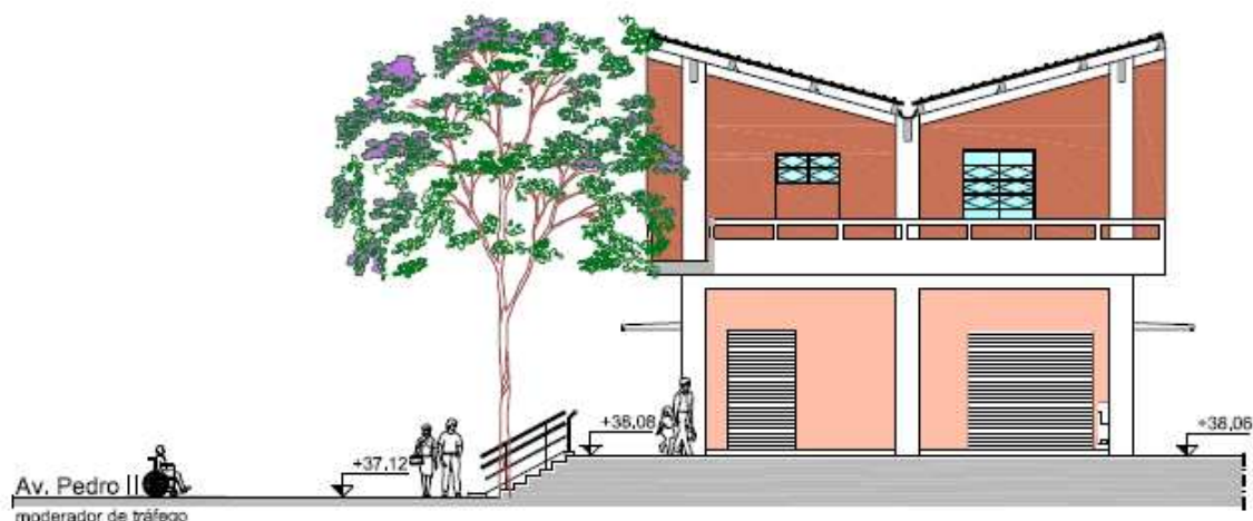
Fig. 12: Corte transversal. Da esquerda para a direita: faixa elevada para redução do tráfego da Avenida Dom Pedro II; a calçada de três metros; a faixa intermediária destinada às rampas, escadas e canteiros e a circulação de 3,00m junto às lojas. Por fim, o hall com pé-direito duplo do bloco administrativo.
