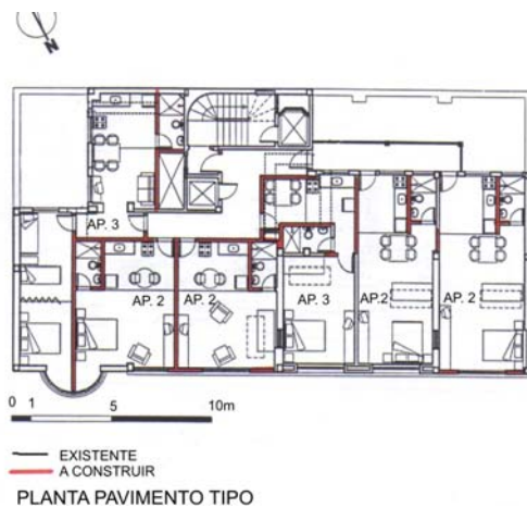
Figura 3. Planta pavimento tipo, Edifício Maria Paula Fonte: Câmara Municipal de São Paulo, 2001
